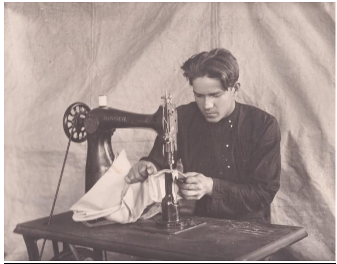
Ремонт дыхательного мешка
